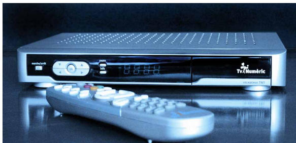
Settop-Box: Decoder für die Signale, die über die Hausantenne empfangen werden
