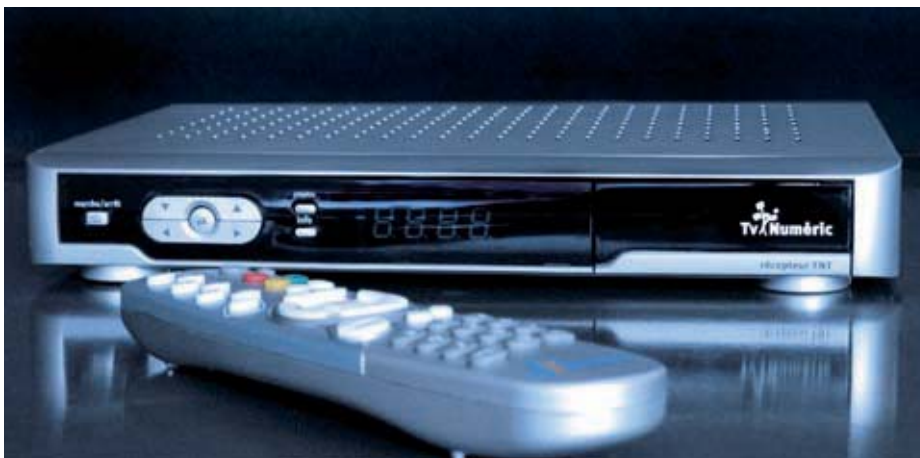
Settop-Box: Decoder für die Signale, die über die Hausantenne empfangen werden.
